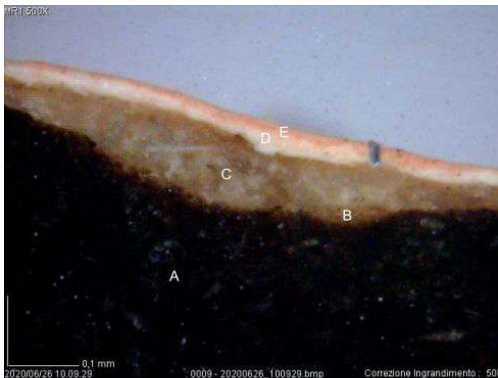
Foto al microscopio digitale, sezione lucida del campione MR1, luce bianca riflessa, ing. 500X.
